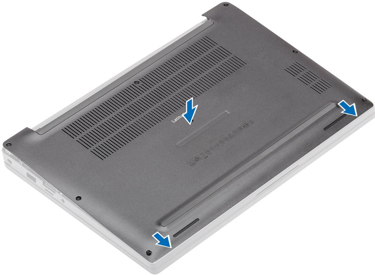
2. Presione los bordes de la cubierta de la base hasta que encaje en el ensamblaje del reposamanos.
