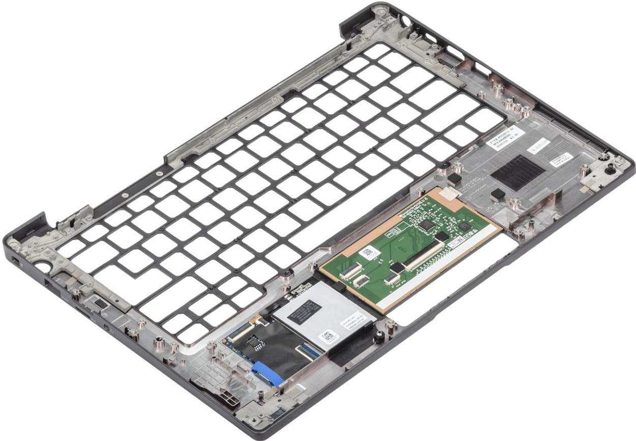
2. Instale los siguientes componentes en el nuevo ensamblaje del reposamanos:
